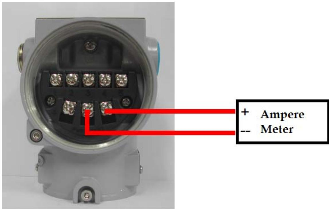
그림 6-1. Loop 전류의 측정 단자
