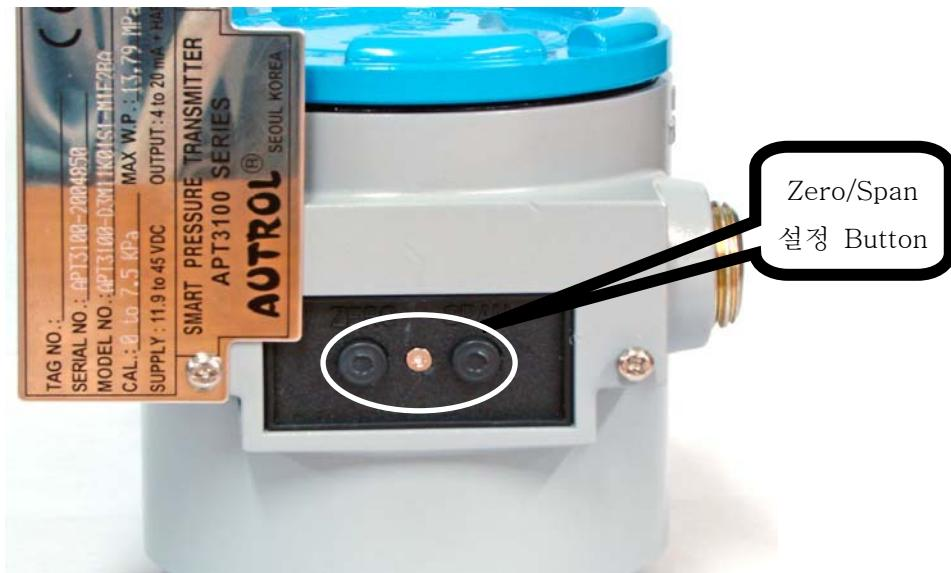
그림 3-7. 전송기의 Zero/ Span 설정 Button
