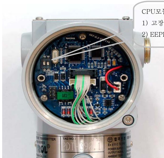
그림 3-6. CPU모듈의 고장모드 및 EEPROM-Write 선택 스위치
