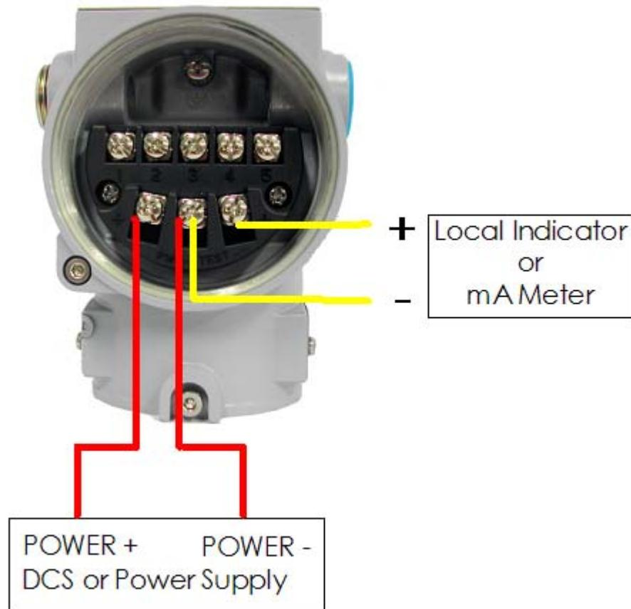
그림 4-3. 전원 및 테스트 단자의 연결
