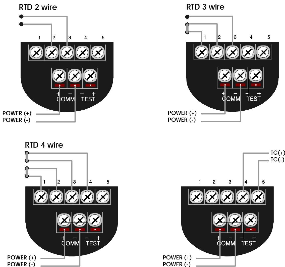
그림 3-1. ATT-2100 온도 전송기의 센서 연결
