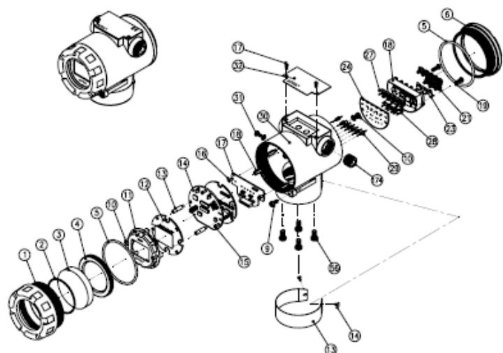
그림 1-1. Model ATT-2100 Transmitter Expoded View (Housing)
